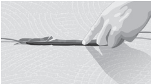
Kuva 3. Kylmä- ja lämmityskaapelin liitosura
