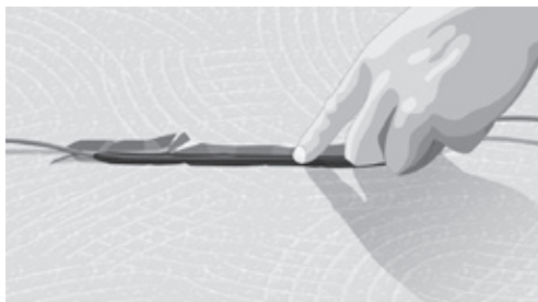
Fig. 3. Spor for kobling mellom kaldkabel og varmekabel
