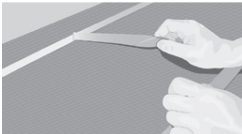
Fig. 6. Udlæg dobbeltklæbende tape, og fjern lineren
