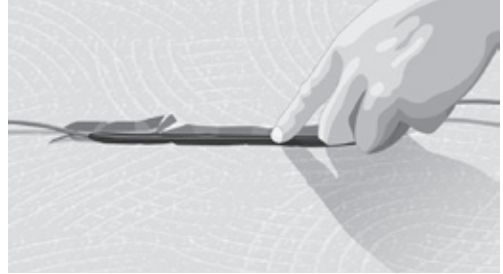
Bild 3. Spår för fog av kyl- och värmekabel
